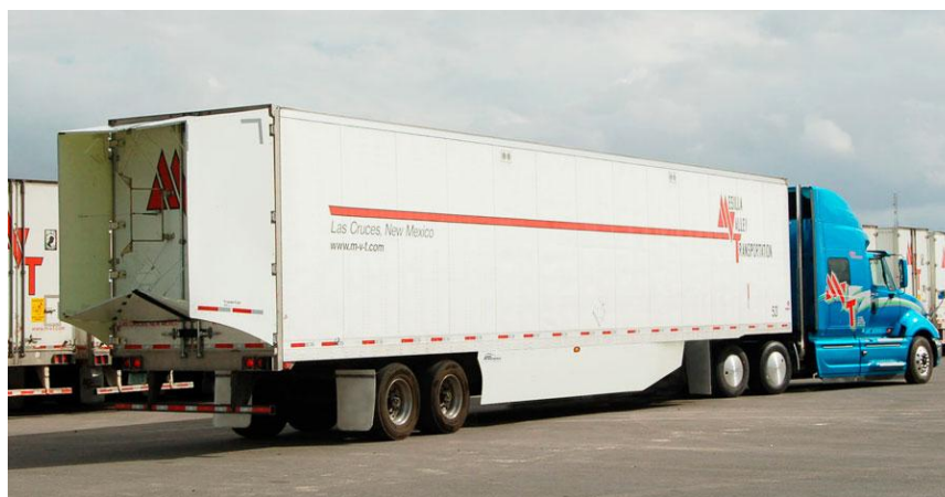
Рисунок 5 – Пример тестирования аэродинамического «хвостовика» компанией MVTS
