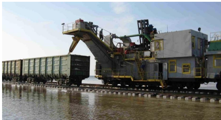
Рисунок 3 – Работа подборщика на озере по добыче соли
