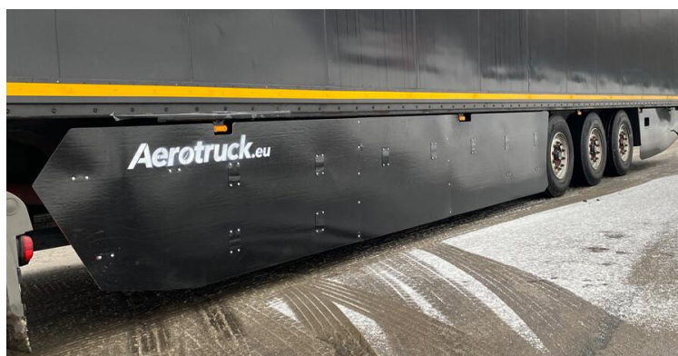
Рисунок 4 – Пример использования аэродинамической «юбки» для полуприцепа компанией «Деловые линии»
